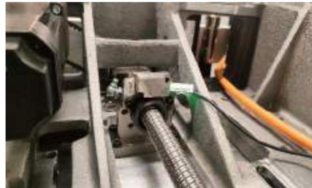
Soluzione: sono stati montati diversi sensori che rilevano la vibrazione su tre assi e la temperatura di contatto, raccolti su master IO-Link che fanno capo ad un Edge computer di nostra produzione che automatizza il riconoscimento dei dispositivi e la storicizzazione dei dati
